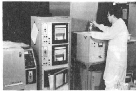
伝導熱量計による水和熱測定
