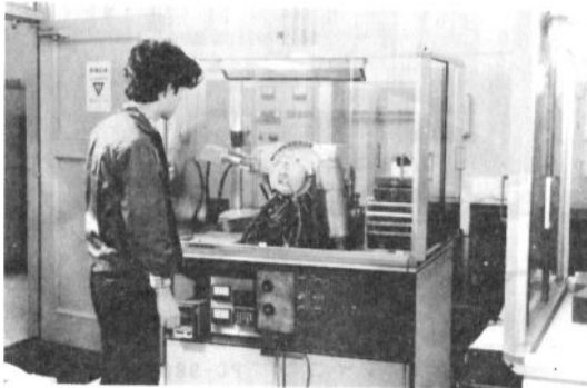
試料水平型高温 X 線回折計
