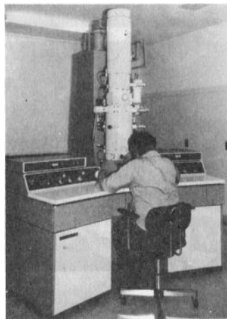
200KV透過電子顕微鏡
