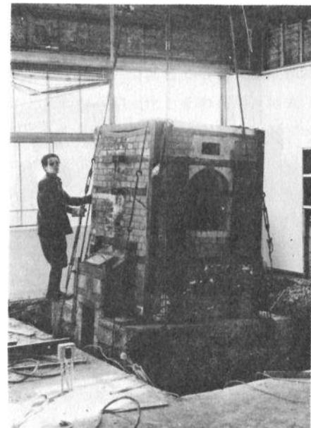
移設中の石炭焚試験窯
