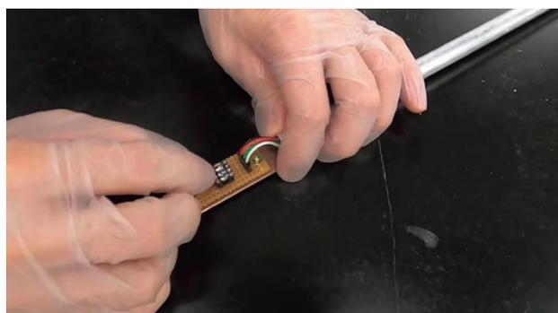
図 1 超伝導体の電気抵抗測定の準備をしている様子（試料を配線した IC ソケットを基板にはめ込む）
